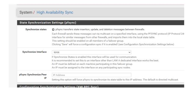
Maintenant on va cocher la synchronisation, mettre l'interface qui est utiliser comment synchronisation et l'ip de la pfsense a synchroniser
